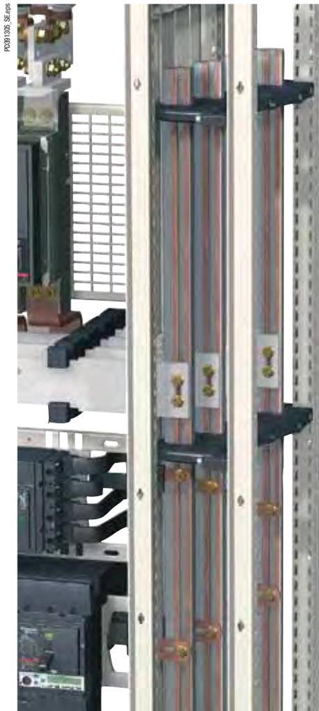
Силовые шины **Linergy** устанавливаются в шинной зоне, расположенной справа или слева от зоны коммутационной аппаратуры. Шины крепятся к раме при помощи держателей, которые обеспечивают также смещение шин относительно друг друга. Все точки подключения доступны непосредственно с передней стороны распределительного щита. Благодаря профилю шин, образующему желоб, отходящие цепи можно легко подсоединить с обеих сторон на любой высоте без предварительного проделывания отверстий.
